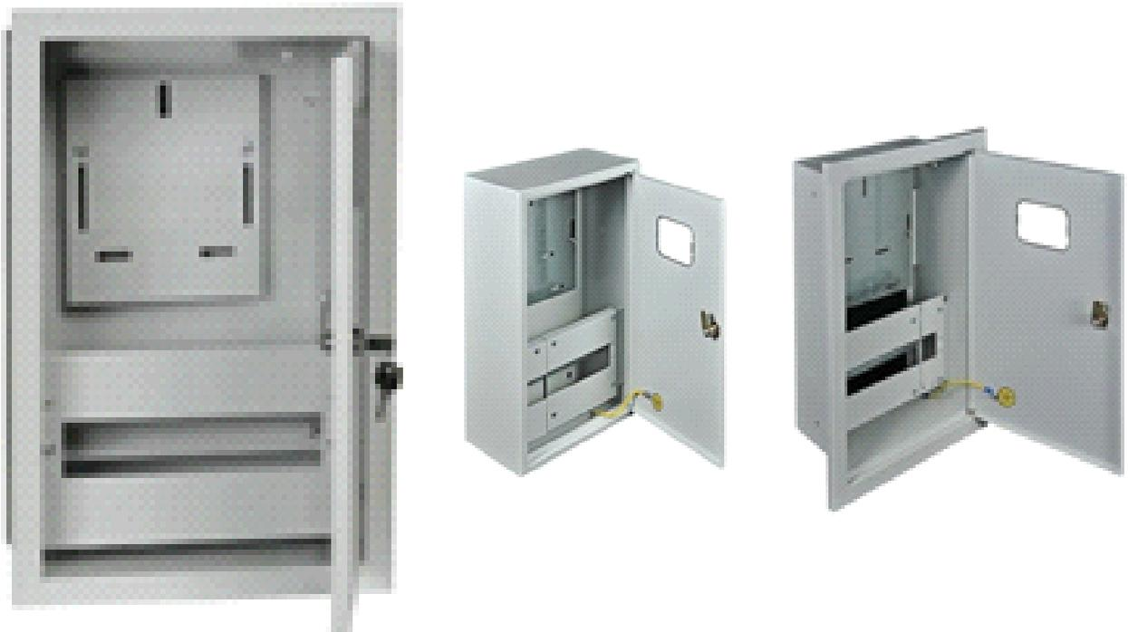
Металлокорпуса ЩУРН, ЩУРВ предназначены для сборки учётно-распределительных электрощитов с использованием модульной аппаратуры, для ввода электроэнергии, ее учета и распределения, а также защиты сетей напряжением 380/220В от токов перегрузки и короткого замыкания.
